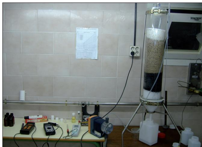
Fig. 5. Columna de lixiviación con óxido de Mg y carbón activo
